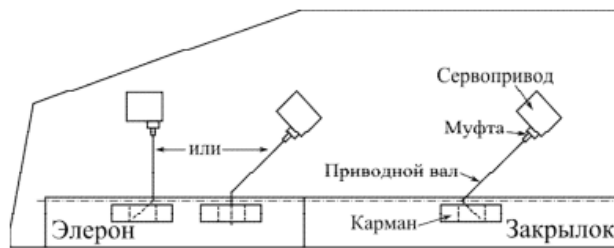
Рис. 4. Конструкция системы передачи усилия элеронам при расположении исполнительного механизма в консоли крыла летательного средства. Дальнейший расчет выполнялся для системы управления элеронами российского ближнемагистрального пассажирского самолёта Sukhoi Superjet 100 . В качестве механизма управления выбирается электромеханический привод в связи с возможностью создания летательного средства с полностью электрифицированным оборудованием и централизованной системой электроснабжения.
