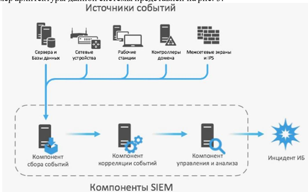
Рис. 3. – Архитектура SIEM-системы
