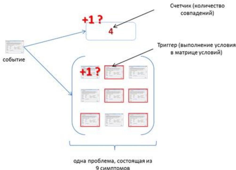
Рис. 5 – Принцип срабатывания правила корреляции
