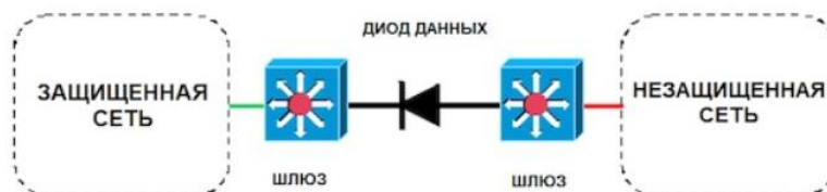
Рис. 1. – Концепция работы диода данных
