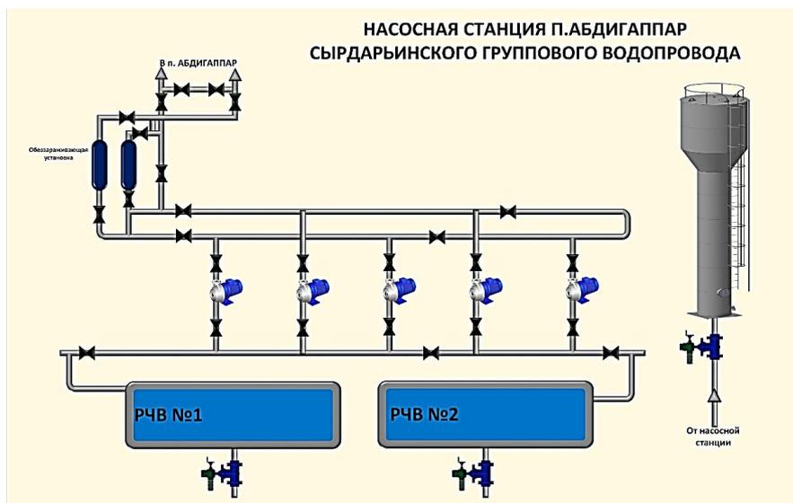
**Рис. 1.** Схема насосной станции поселка Абигаппар
