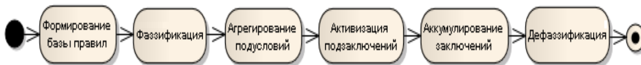
Рис. 1. Схема этапов нечеткого вывода Мамдани.
