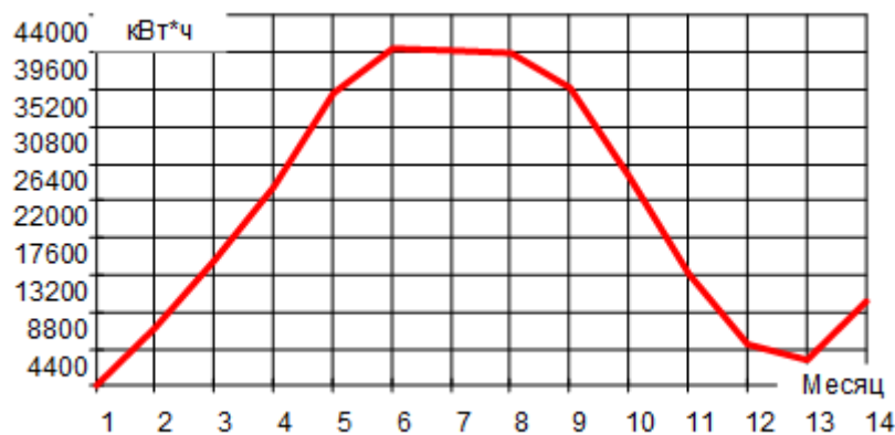
Рис. 3. Динамика помесячного заряда аккумуляторов при использовании солнечных генераторов
