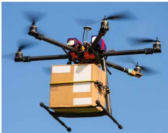
Рис. 2. Транспортировка груза на жестком подвесе
