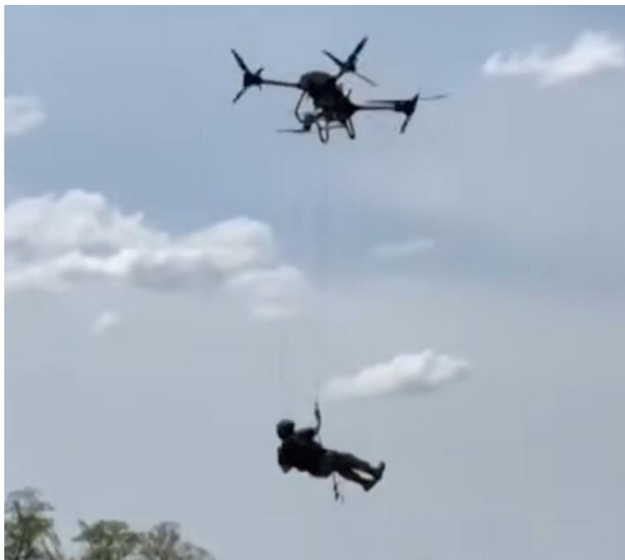
Рис. 1. Транспортировка человека квадрокоптером «Перун»
