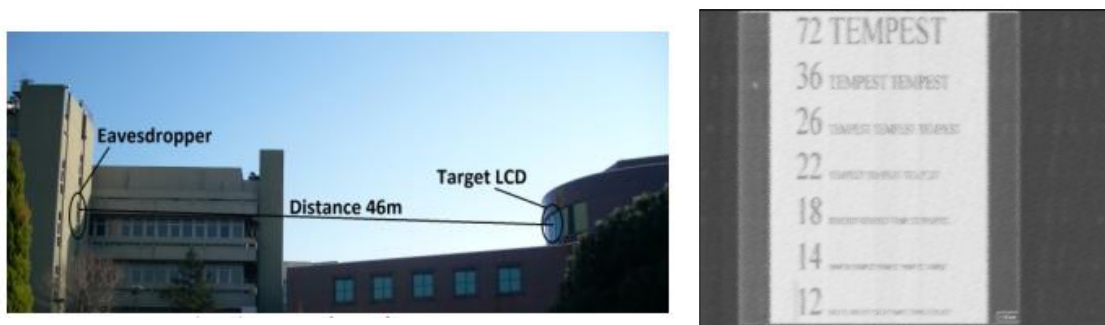
Рис. 3. Схема размещения аппаратуры (слева) и результат перехвата с расстояния 46 метров (справа)
