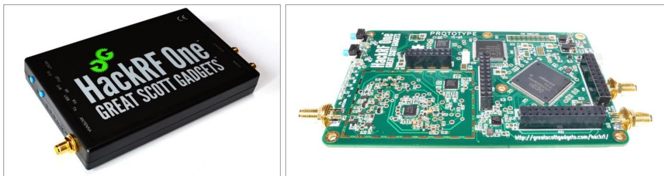
Рис. 2. Внешний вид (слева) и внутренние компоненты (справа) цифрового приемника Hack RF One
