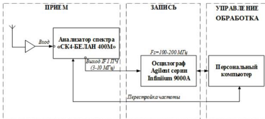
Рис. 5. Структурная схема измерительного комплекса отложенного анализа сигналов ПЭМИН
