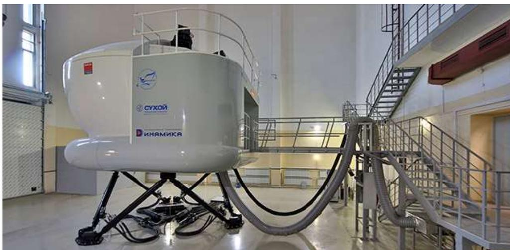
Рисунок 1 - Система подвижности для авиационного тренажера
